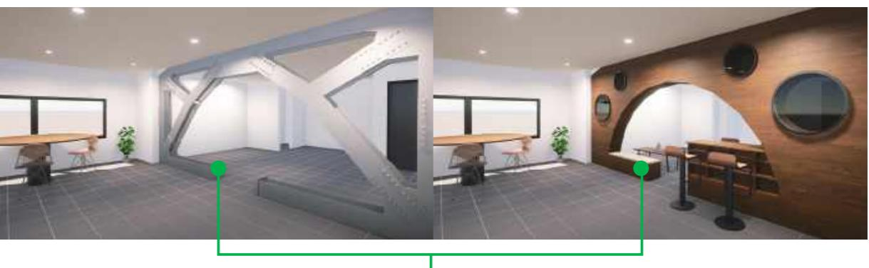
鉄骨耐震プレースはそのまま使用すると野暮ったさが感じられ、デザイン性が損なわれてしまいますが、部屋を区切ることなく通り抜けできるタイプを選び、耐震補強土台にベンチや棚を作成することで、建物の機能を妨げることなく高耐震化を進めることができました。
